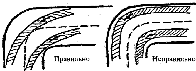
Рис. 32. Способы управления автомобилем на повороте в гололед
