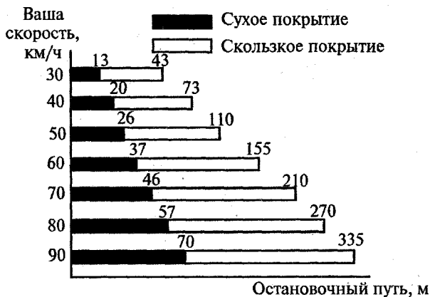
Рис. 43. Зависимость остановочного пути от скорости движения и покрытия дороги
